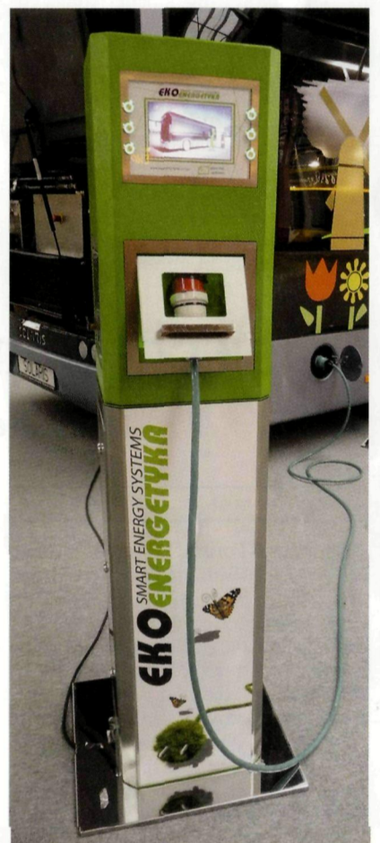
Tak ma wyglądać stacja ładowania akumulatorów do elektrycznych autobusów marki Solaris Fot. Klaudiusz Madeja
